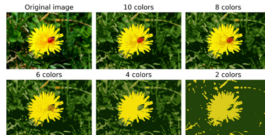
Figura 9.12. Segmentación de una imagen utilizando k-medias con varios números de grupos de colores.
